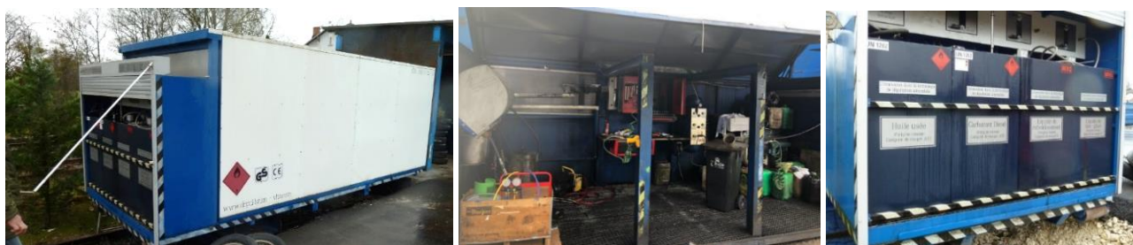
Figure 3. Exemple Station de dépollution des VHU.
